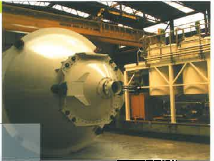
Silo met trilbodem Silo with a vibrating bottom Silo avec a fond à vibration Silo mit einem vibrierendem Boden
